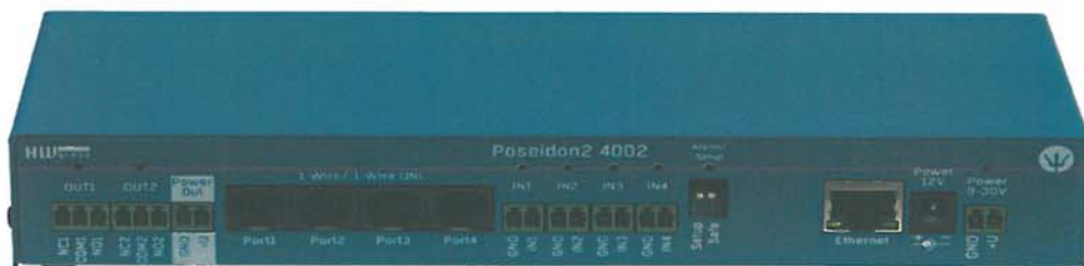
Fot. 1 – Urządzenie monitorujące - Poseidon2 4002
